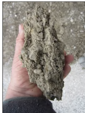
Bereits eingebautes Frostschutzmaterial, hoher Feinanteil
